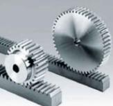
**Рейки, речная передача (кренальера)** модулем с 1-го до 40-го, рабочей шириной рейки до 630 мм., длиной до 4500 мм., с исходным контуром по ГОСТ 13755-81 с прямыми или косыми зубьями.
