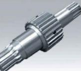
**Вал-шестерни** с динамической балансировкой, длиной до 6000 мм., диаметром до 1200 мм. Возможно изготовление с различными зубчатыми венцами: цилиндрическими прямозубыми, цилиндрическими косозубыми и коническими с круговыми зубьями.
